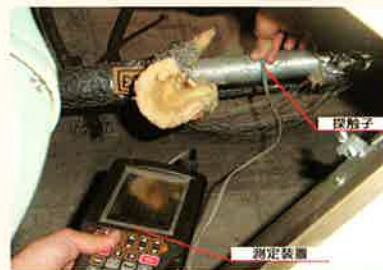
円周方向8等分 長さ方向20mm間隔で10等分の例
